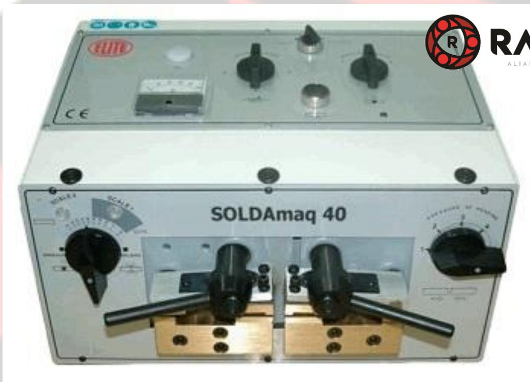
**Soldadura de sierra cinta “Pulsar y listo”:** Solamente tienes que seguir los parámetros de soldadura que te proporcionamos en función del grueso y ancho de la sierra, cerrar las mordazas de fijación de la sierra y pulsar el botón de soldadura.
